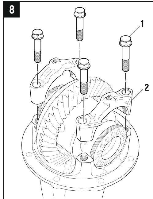
**3.12** Открутите болты крепления **(1)** и снимите крышки подшипников **(2)**. **(Рис.8)**
