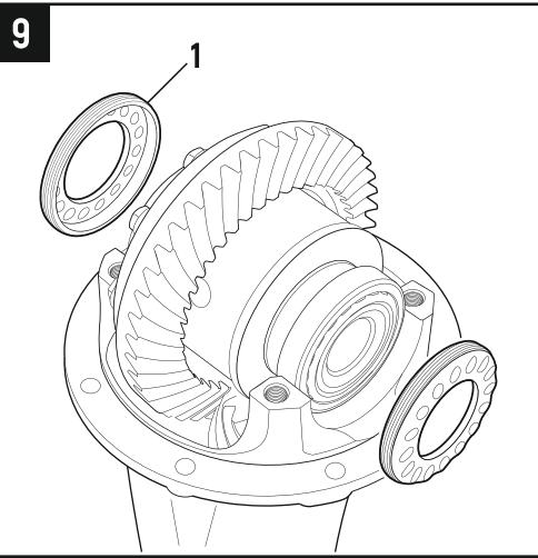
**3.13** Снимите регулировочные гайки (1).
