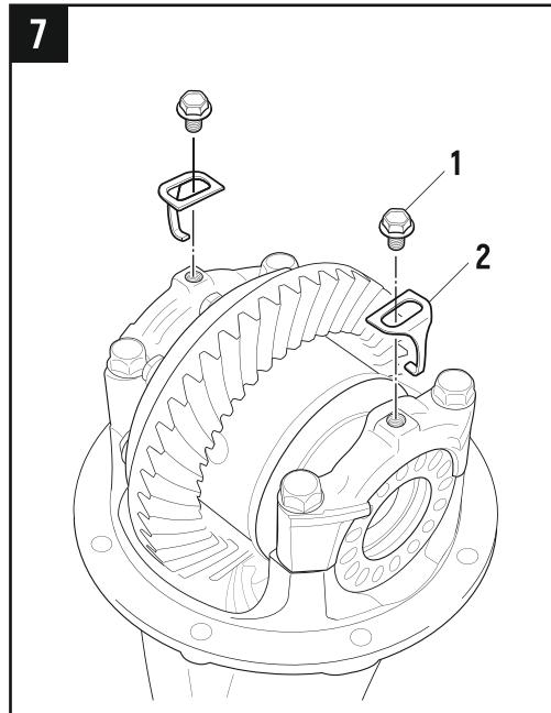
**3.11** Открутите болты крепления **(1)** и снимите стопорные пластинки **(2)**. **(Рис.7)**
