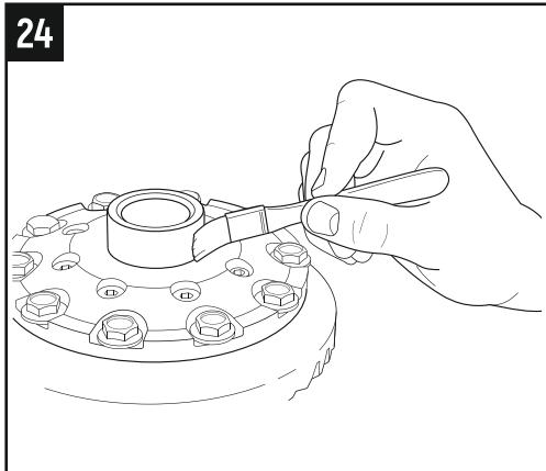
4.5 Нанесите консистентную смазку на поверхность шеек дифференциала.
