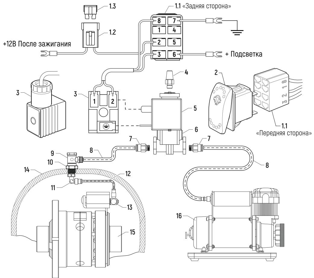
1. Комплект проводки (1.1 Разъём переключателя; 1.2 Разъём предохранителя; 1.3 Предохранитель ЗА; 1.4 Кабель, провода)
