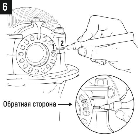
**3.10** Используя маркер, нарисуйте линию **(1)** на поверхности регулировочной гайки и аналогичную линию **(2)** на поверхности крышки подшипника. Для одной стороны используйте маркировку в одну линию, для обратной в две линии. **(Рис.6)**
