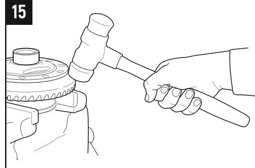
3.18 Используя молоток с пластиковым, резиновым или медным бойком, сбейте ведомую шестерню с коробки дифференциала. Во избежание заклинивания ведомой шестерни обстукивайте её равномерно по окружности (Рис. 15)
