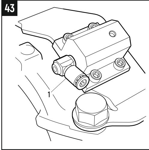
4.30 Прикрутите угловой фитинг «33» (1) к пневмоцилиндру с помощью шестигранного ключа на 2.5 мм. (Рис. 43)
