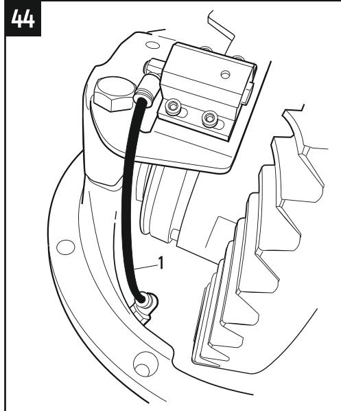
4.31 Определите необходимую длину пневмопротивы «17» (1), после чего выполните прямой срез. Место среза должно быть ровным, не допускайте рваных краёв. Установите пневмопротиву соединив угловые фитинги. (Рис. 44)
