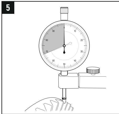
**3.9** Удерживая фланец ведущей шестерни, покачайте ведомую шестерню вперёд и назад до упора и остановки стрелки на шкале индикатора [Рис. 4, Рис. 5]. Запишите полученное значение в соответствующую строку таблицы. (Значение 1).
