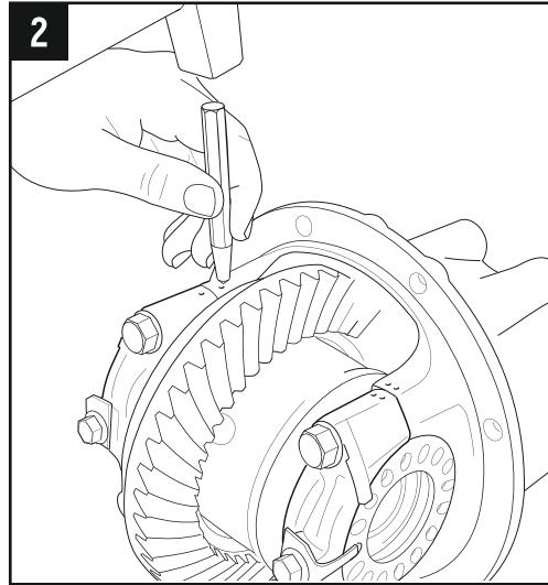
**3.7** Используя небольшой заостренный кернер, обозначьте стороны крышек подшипников. Засечки должны находиться на поверхности крышек подшипников и прилегающей к ним части картера. Для одной стороны используйте маркировку в две засечки, для другой в одну как показано на рисунке. **(Рис.2)**
