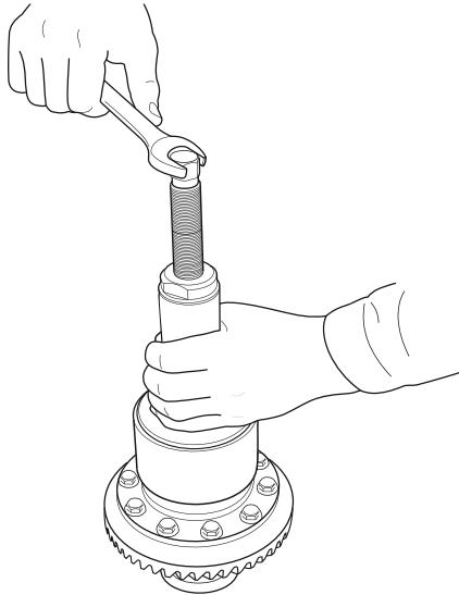
3.16 Спрессуйте подшипники с корпуса дифференциала при помощи съемника подшипников. (Рис.13)
