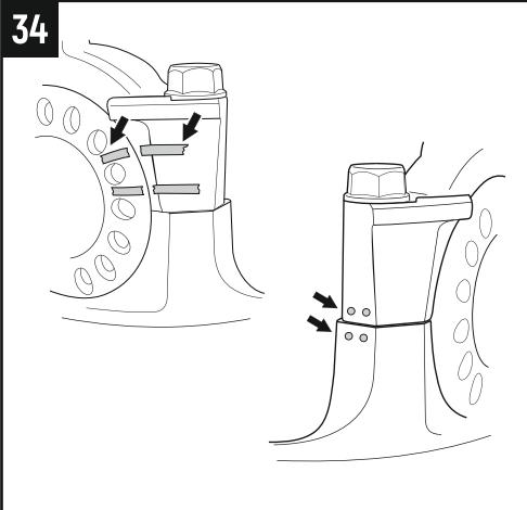
**4.21** Установите регулировочные гайки и крышки подшипников. Маркировка на крышках подшипников должна совпадать с маркировкой на регулировочных гайках, а так же с маркировкой на картере редуктора, смотрите пункты **[3.7, 3.15]**. **[Рис. 34]**
