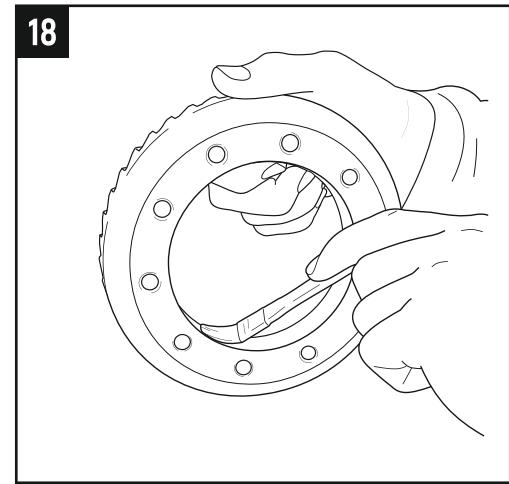
**3.19** Отшлифуйте посадочную поверхность ведомой шестерни, а также корпуса дифференциала с помощью напильника, чтобы удалить все выступы вокруг резьбы и забоины на поверхности. **(Рис.16).**
