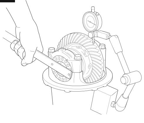
**4.24** Используя индикатор часового типа и ключ для регулировочных гаек, настройте люфт шестерен главной пары выставив значение, полученное при предварительном замере и записанное в таблицу,смотрите пункт [3.9]. (Рис. 36)
