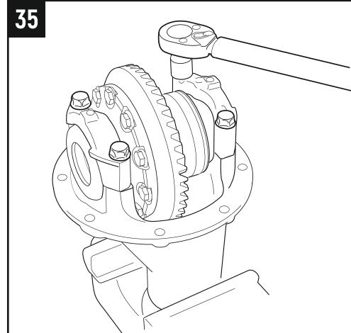
**4.22** Затяните болты крышек подшипников с помощью динамометрического ключа с моментом указанным в руководстве по обслуживанию вашего автомобиля. После затяжки всех 4-ёх болтов ослабьте их для возможности вращения регулировочных гаек. **[Рис. 35]**
