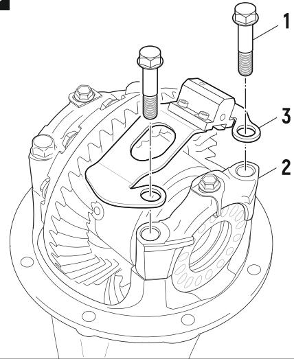
4.28 Установите кронштейн в сборе с пневмоцилиндром (3) на правую крышку подшипника (2). Наживите болты крепления (1) но не затягивайте, кронштейн должен иметь свободный ход относительно болтов крепления. [Рис. 40]
