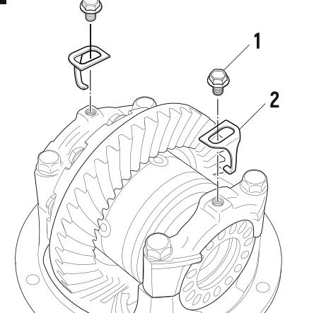
**4.25** Установите стопорные пластины (2) в необходимое положение и затяните их с помощью болтов крепления (1). (Рис. 37)
